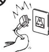
如果拉扯電源線有可能損壞電源線導致觸電・短路・火災。
